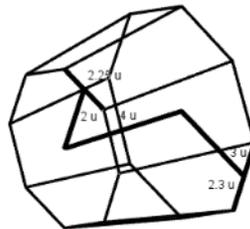
La imagen superior muestra el desglose de los cuerpos geométricos y sus respectivas dimensiones, en particular el centro de la cúpula es una pirámide truncada, por ende, al tener sus dimensiones, se puede utilizar la fórmula y calcular el volumen. El proceso anteriormente descrito se genera análogamente para todas las otras componentes de la estructura, para luego aplicar la aditividad y obtener el volumen total.
