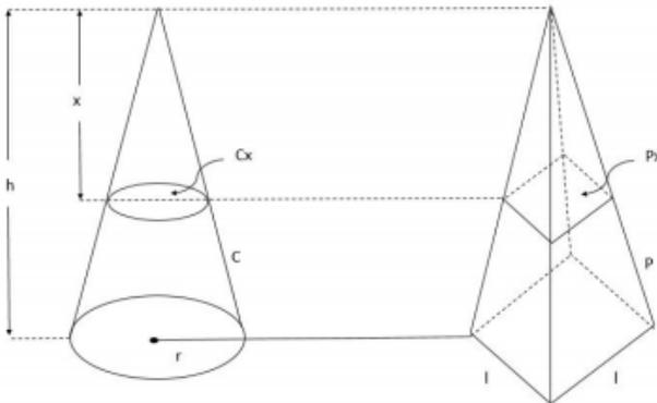
Denotando por C el cono, por P la pirámide y por  $C_x$  y  $P_x$  las respectivas secciones obtenidas por intersecciones de los sólidos con un plano paralelo a las bases y de altura  $x$  medida desde la base. Las áreas de las secciones cada sólido se define como:
